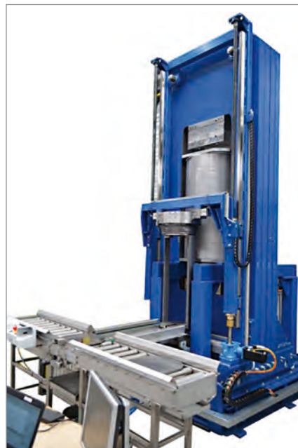
Produktionsanlage mit automatischer Be- und Entladung \varnothing 400 mm, H 1000 mm, bis 400 MPa
