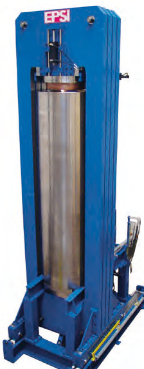
Produktionsanlage \varnothing 800 mm, H 4200 mm, bis 100 MPa
